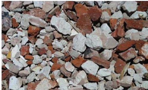
Tiilimurske (kuva: Tero Elo 1999)
